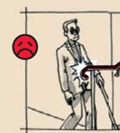
6 - Chaque main courante doit se prolonger horizontalement de la longueur d'une marche au delà de la 1<sup>re</sup> et de la dernière marche de chaque volée de l'escalier sans créer d'obstacle au niveau des circulations.
