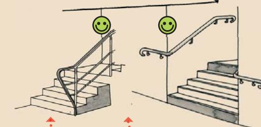
7 - Un éclairage artificiel de 20 lux minimum en extérieur ou de 150 lux minimum en intérieur sans zone d'ombre avec un contraste visuel approprié permettant de différencier la paroi support de la main courante.
